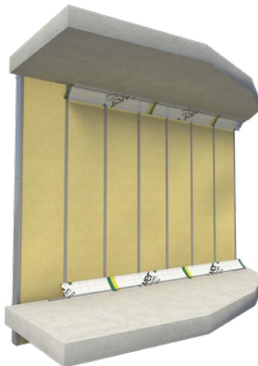
Les lisses Clip'Optima sont fixées dans les dalles inférieures et supérieures d'étage, sur la membrane Vario® Xtra Band.
